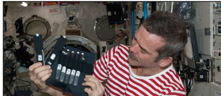
L'astronaute de l'ASC Chris Hadfield présente les détecteurs de neutrons à bulles dans le cadre de l'expérience canadienne de mesure des radiations Radi-N2 [source: NASA, 2013]
