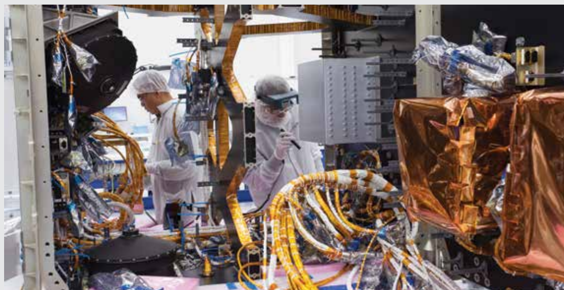
Des ingénieurs inspectent la plateforme du deuxième des trois satellites de la mission de la Constellation RADARSAT aux installations de Magellan. Des batteries sont visibles à l'avant-plan, enveloppées dans des couvertures thermiques. On voit une roue à réaction à gauche. (2016-02-11)
